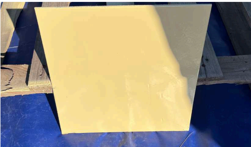
ОДНОСЛОЙНОЕ ПОКРЫТИЕ РЕМ-ПОКС-0707ХС 400 МКМ (ПРОВЕРКА НЕСТЕКАЕМОСТИ МОКРОГО СЛОЯ)
